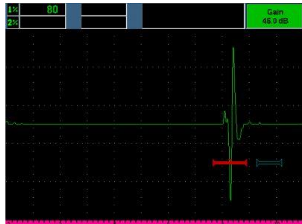
Karakteristik Sinyal dalam Kondisi Disbond / tidak menempel (kondisi tidak baik)
